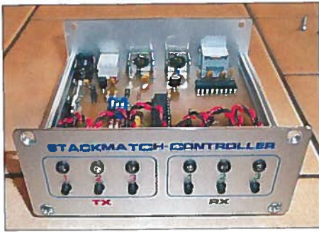
Bild 9: Stackmatch-Steuerung im Gehäuse mit industriell gefertigter Frontplatte; die verschiedenfarbige Beschriftung hilft bei der schnellen Unterscheidung zwischen TX- und RX-Bedienelementen. Fotos: DH8BQA
